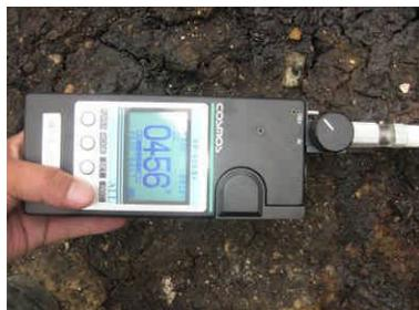
臭気計を使用した散布前の計測では、456を示した。対象区域は、地震の影響で地盤沈下が起き満潮時には灌水する。そのため、海産物の油が地表に押し上げられ、土壌の表面に水たまりを作っていた。臭気は土壌全体に漂っていた。
